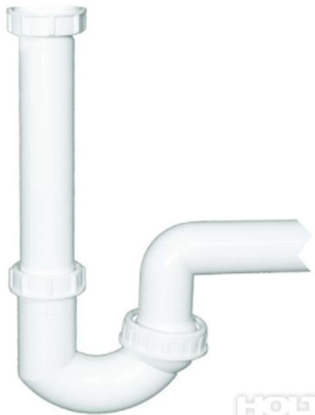
HL Sifon HL100G/40 PP, Kugelgelenk, Tauchrohr höhen- verstellbar DN40 6/4'
