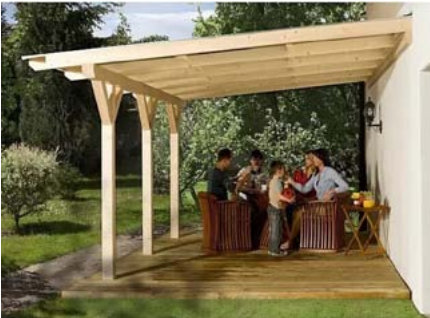
Referenzbild Holzriegelkonstruktion mit Pultdach
